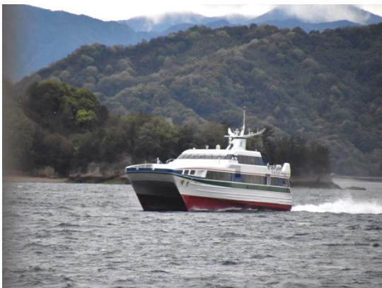
石崎汽船の広島/呉～松山航路の「瑞光」。日立造船建造の水中翼で浮き上がって34ノットで疾走します。このクラスの4隻も建造から約25年になります。
