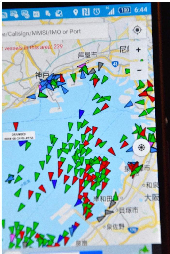
台風のために、たくさんの船が大阪湾上でアンカリングしている中、一路、大阪港に向かう「おれんじ8」(右向きの青マーク)の姿が画面左に確認できます。青が客船、緑が貨物船、赤がタンカー、灰色がタグなどです。南の風で係留船はみな下向きですが、移動を開始した数隻が違う方向に航行しているのがわかります。
