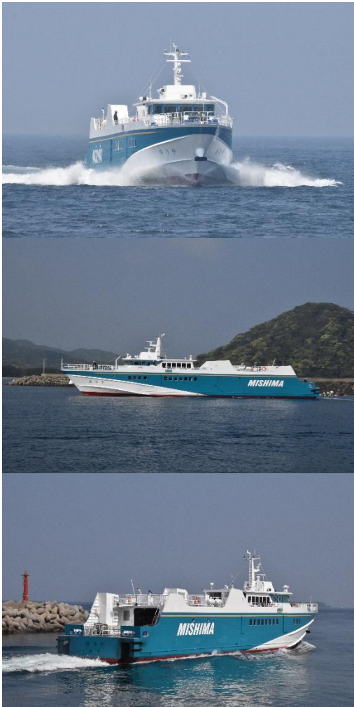
新造船「ゆりや」。「おにようず」の代替船で三菱造船下関の建造の高速アルミ船です。
