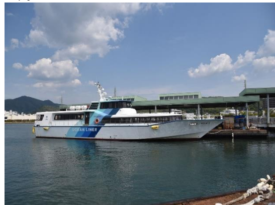
時津港に係船中の「たいよう」。106総トン、24ノットと安田産業汽船のフリートの中では最も大型の高速旅客船です。
