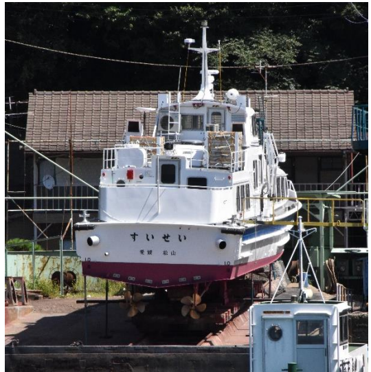
三津浜の造船所の船台で修理中の高速旅客船「すいせい」。
