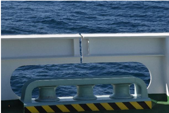
ブルワークの上部の切込みにご注目!!船員の係船作業が楽になったとのこと。
