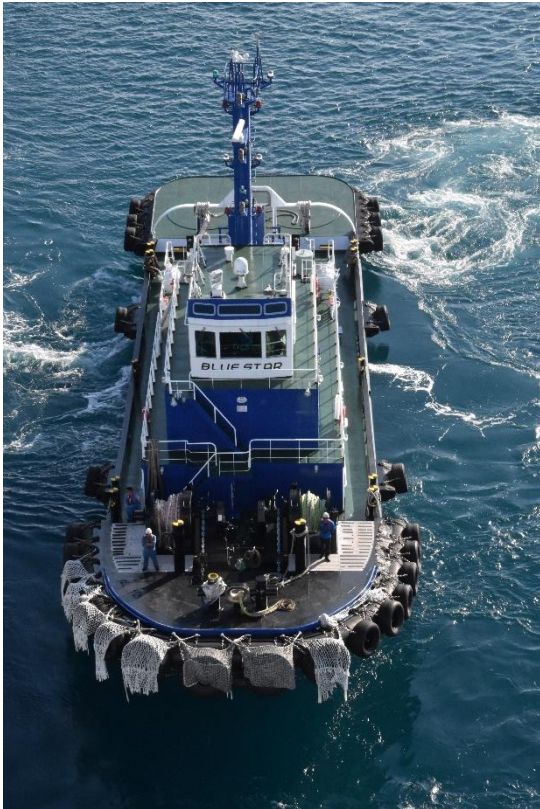
船首の綱とり作業には、タグボート Blue Star があたりました。船首に係船綱を下ろし、それを海上の係船柱まで運んで、あとは人力で綱をかけてました。
