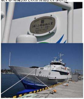
「希海」(のぞみ)は、2019 年に釜石の小鯖船舶工業で 建造された。98 総トン、全長 36.5m、幅 6.5m、最大速 力 23.5 ノット。
