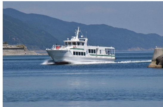
「しまかぜ」。「しまちどり」の写真に比べると、窓の配置、ブリッジ形状等に違いがみられます。
