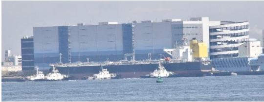
タグボート4隻に押されて着岸中の「プサカ・ボルネオ」です。煙突の背後に巨大なスクラバーが取り付けられています。
