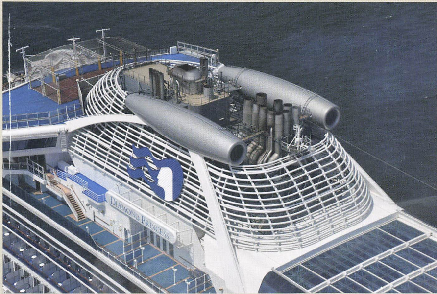
最近のディーゼル機関船では複数の排気管が束ねられて、1つの化粧煙突にまとめられています。化粧煙突にはファンネルマークが取り付けられています。写真は天保山岸壁に停泊する「ダイヤモンドプリンセス」の煙突を観覧車から見た写真です。
