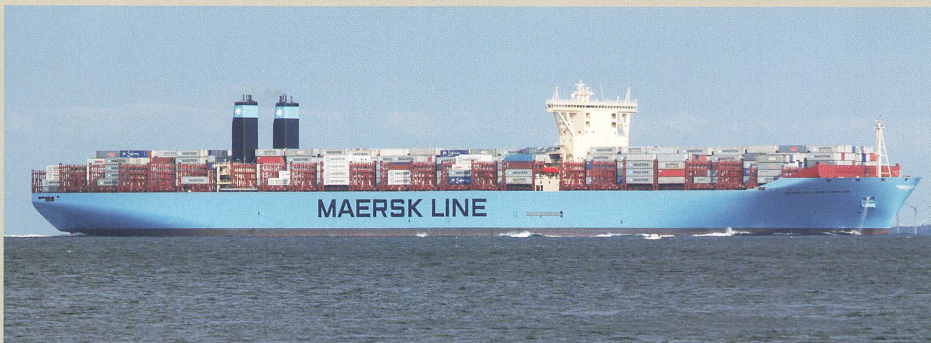
コンテナ船では、大型化に伴ってシングル・アイランド型(上の写真)からツイン・アイランド型(下の写真)に変わりました。
