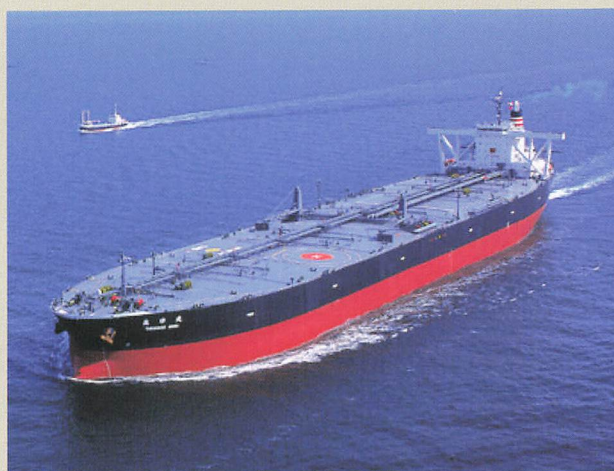
船楼をもたない平甲板型の大型タンカー。上甲板の上には、船尾に居住区があり、その最上階が操舵室になっています。(日本郵船提供)
