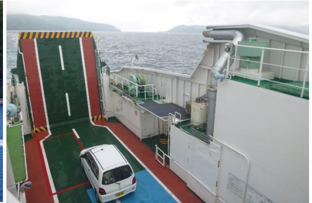
「フェリーどうぜん」の船尾側車両甲板、排気口
