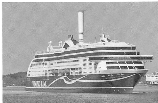
ローターセイルを搭載したLNG燃料フェリー「バイキング・グレース」
