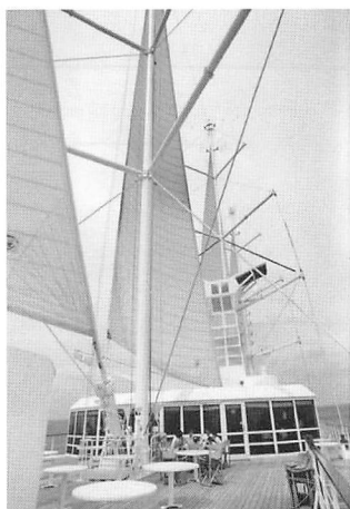
クルーズ客船「クラブメド2」の完全自動の帆走システム
