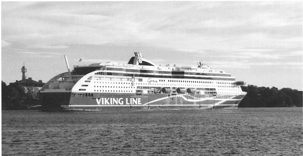
世界最初のLNG燃料の大型カーフェリー「バイキング・グレース」は、2013年にバルト海に登場した。船尾の暴露甲板に2つのLNGタンクを搭載している。
