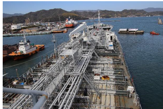
艤装中のケミカルタンカーのデッキ上の複雑なパイプ構造です。
