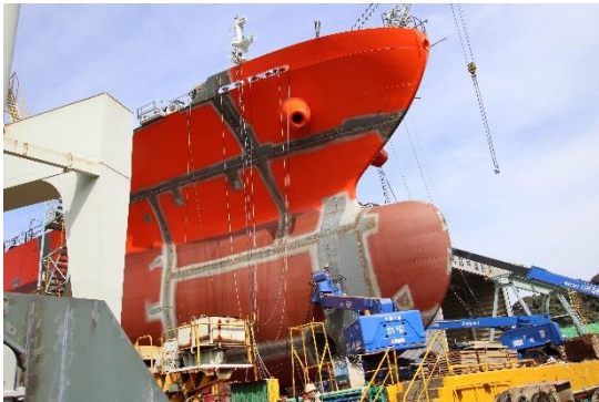
臼杵造船の船台で建造中のケミカルタンカー
