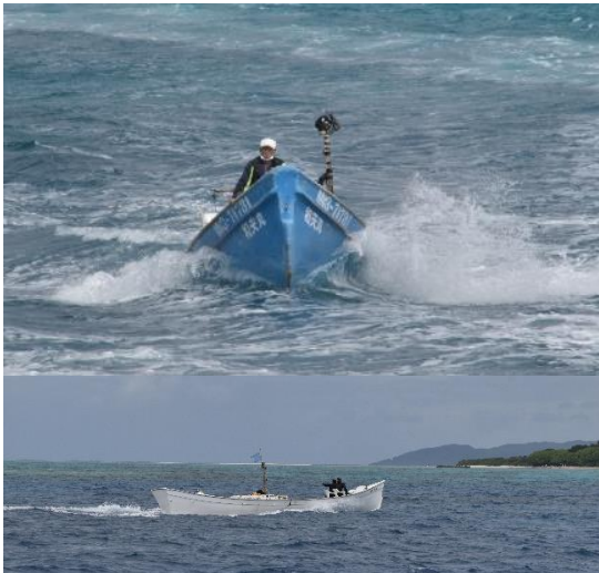
沖縄独特の漁船「さばに」。斜めの舷側版とトランサム型の船尾、大きなシアーが特徴です。
