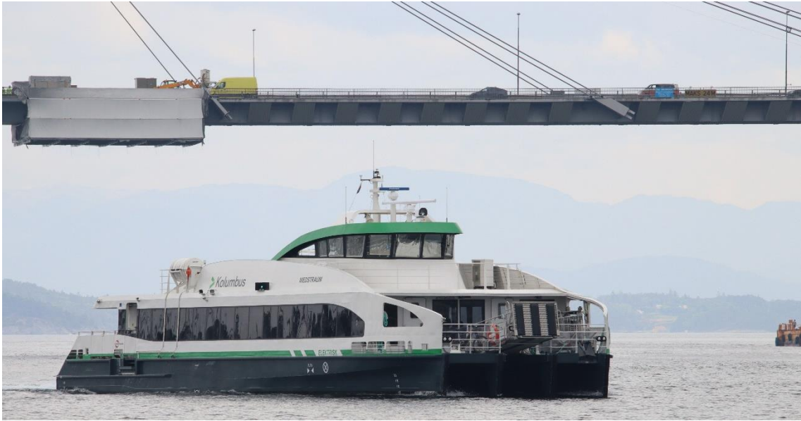
スタバンガーの中心と近郊の町とを結ぶ高速旅客船です。船首に旅客の乗下船用のタラップを有しています。
