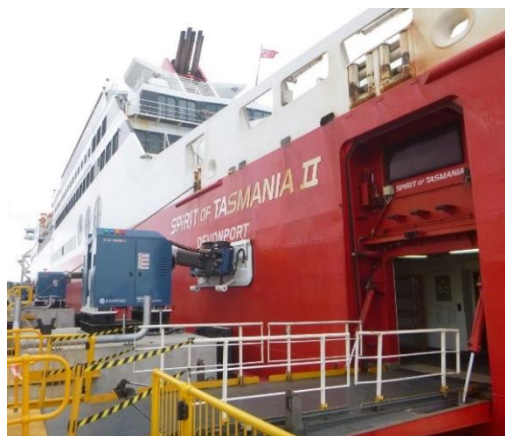
CAVOTEC VACUUM MOORING SYSTEM（真空自動係船装置） 中央の写真の右側は徒歩乗下船口
