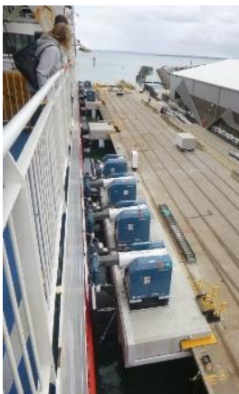
CAVOTEC VACUUM MOORING SYSTEM（真空自動係船装置） 中央の写真の右側は徒歩乗下船口
