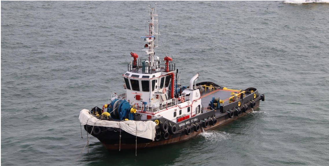
大型のクルーズ客船はタグボートをほとんど使いませんが、「スペクトラム・オブ・ザ・シーズ」の出港時には船尾に1隻のタグボートが付き、ロープをとって牽引作業をしていました。
