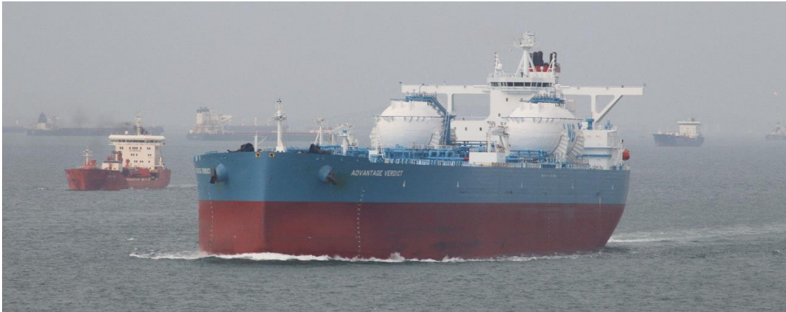
LNG 燃料のタンカーのようです。LNG 燃料タンクが 2 つデッキ上に設置されていました。
