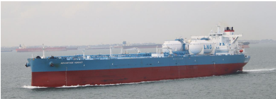
LNG 燃料は CO2 排出を原油に比べて 25~30%削減することができるため、LNG を燃料とする貨物船も急激に数を増し、LNG 燃料であることをアピールするようになっています。
