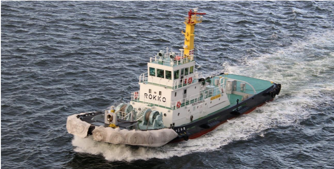
着岸時のサポートについたタグボート「ろっこう丸」です。「スペクトラム・オブ・ザ・シーズ」はバウスラスターとポッド推進器を駆使して自力で着岸したので、万一のための監視・支援が役割です。
