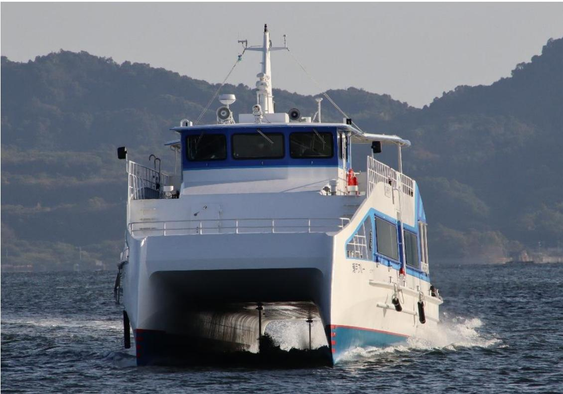
広島港の宇品に入港してくる新造船「瀬戸ブルー」です。双胴間に水中翼が設置されていて、揚力で浮上して高速をだすとともに、運動制御もしています。船体は江田島市が建造して、運航は瀬戸内海汽船グループの瀬戸内シーラインが行う上下分割方式です。
