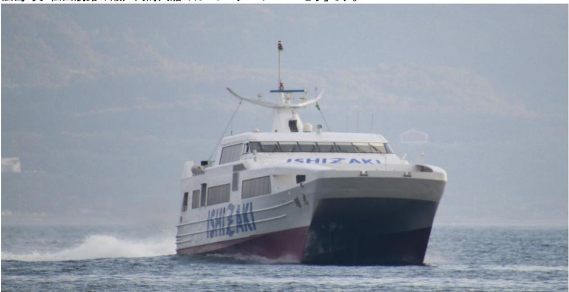
広島-呉-松山航路の石崎汽船の高速旅客船「瑞光」です。双胴間の中水翼に働く揚力によって船体がかかり浮き上がっているのがよくわかります。
