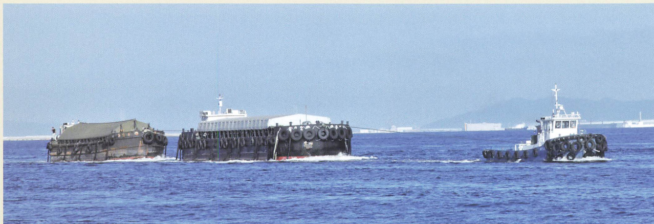
荷物を積んだバージを牽引するタグボートです。湾内、港内、河川、運河等での荷物輸送に携わっています。
