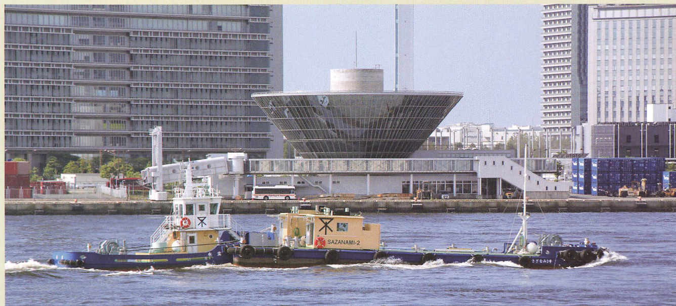
プッシャーバージに押されて航行する大阪港の給水バージです。(撮影:市栄正樹)
