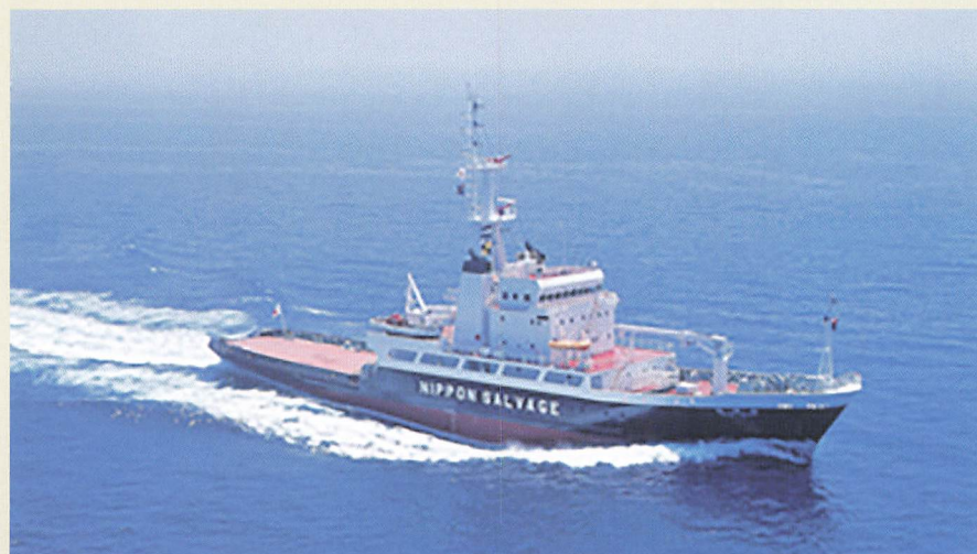
日本サルベージの航洋タグ「航洋丸」です。海難現場に迅速に駆けつけるためのスピードと、大型船を牽引する力の両方を兼ね備えています。(写真提供:日本サルベージ)
