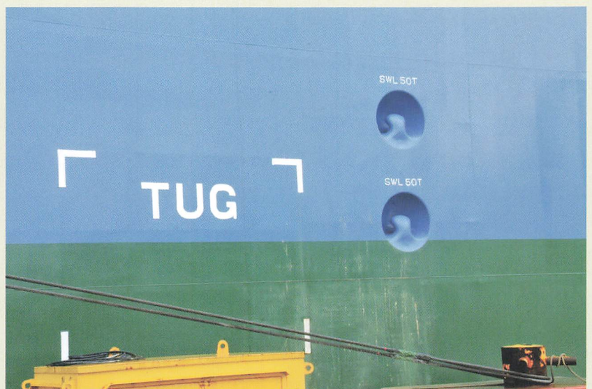
大型船の船側にあるTUGマーク。 タグボートで押しても損傷しない強度があることを示しています。
