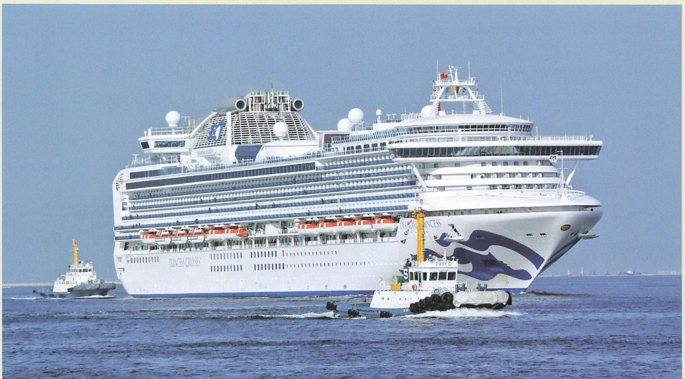
大型クルーズ客船の離着岸支援にあたるタグボートは、白い船体を汚さないようにタイヤの防舷材を白い布で覆っています。
