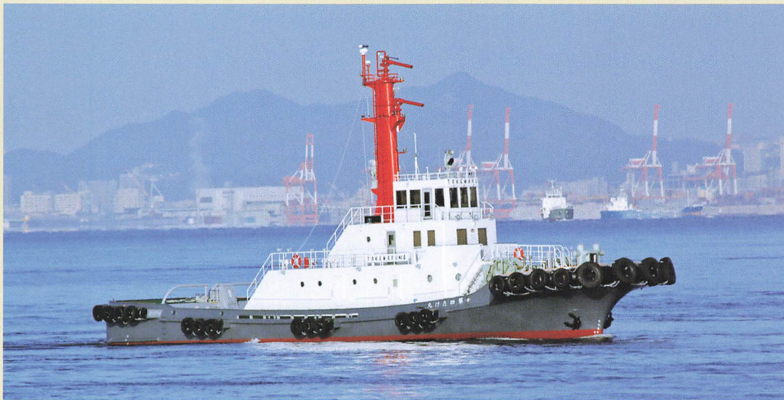
ハーバー・タグ「第4たけ丸」。マストには消火用放水銃が設置され、消防艇としても活躍できるようになっています。
