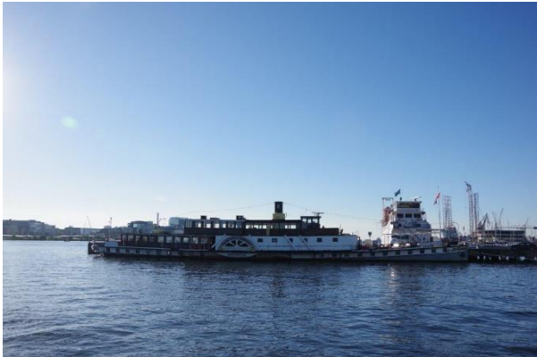
1912年製の外輪船「KAPITEIN ANNA」NDSMにて (現在はディーゼルのホテル/パーティ船) 元、KAPITEIN KOK、REEDERIJ OF DE LEK 6
