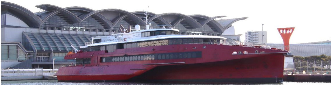
博多港に停泊する「クイーンビートル」。オーストラリアのオースタル・シップ建造のアルミ製トリマラン型高速旅客船です。日の当たり方で赤い船体の印象がかなり異なります。
