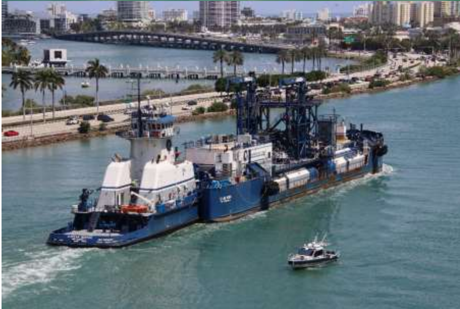
クルーズ客船の LNG 燃料化が進み、マイアミ港にも LNG バンカリング船が 2 隻登場しています。バージ型でプッシュャーボートが押して移動します。
