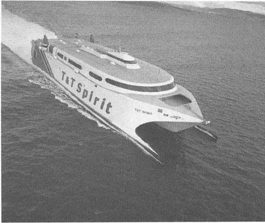
図-7 船首を尖らせて、波を貫通して進むコンセプトの波浪貫通型船型が1990年代にオーストラリアで開発された（提供：INCAT Tasmania）
