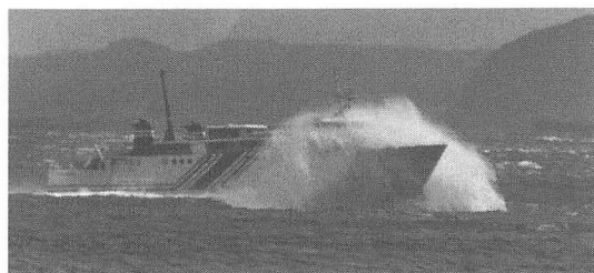
図-5 荒れた海上を進む船は大きな縦揺れをしながら進む。特に船首部では大きな上下加速度が発生して船酔いにつながる。
