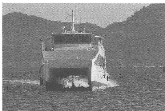
図-12 水中翼付き双胴高速旅客船。水中船底の水中翼で浮上し、かつ運動制御を行って乗り心地の改善を行っている。
