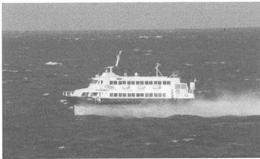
図-8 完全に水中に没水させた水中翼で船体を支えるジェットフォイルは、波浪中でもほとんど揺れない究極の運動性能をもつ
