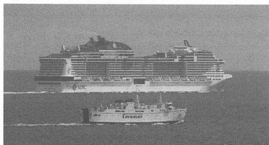
図-6 大型化して300m以上の船長になると船体運動は小さくなり船酔いの心配はなくなる。奥の船は長さ331mの大型クルーズ客船、手前の小型船は長さ70mのカーフェリー。
