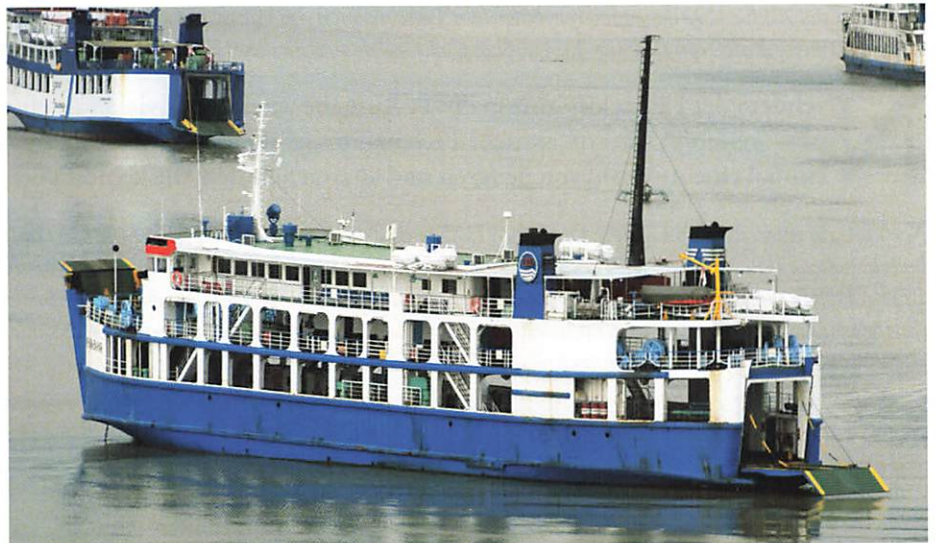
Foto links: Bunt geht es auch mit unserem Bilderbogen über die indonesische Fährwelt zuende, denn der zwischen Lembar und Padangbai eingesetzte Doppelender PBK MURYATI (850 BRZ/Bj. 1995 als OSHIMA NO. 12 ) zeigt sich besonders farbenfroh. Das Schiff ist 58,45 m lang, 14 m breit, bietet 350 Passagieren und gut 30 Autos Platz und ist hier ebenfalls auf der gut besuchten Reede vor Lembar zu sehen. Foto: Gerolf Drebes
