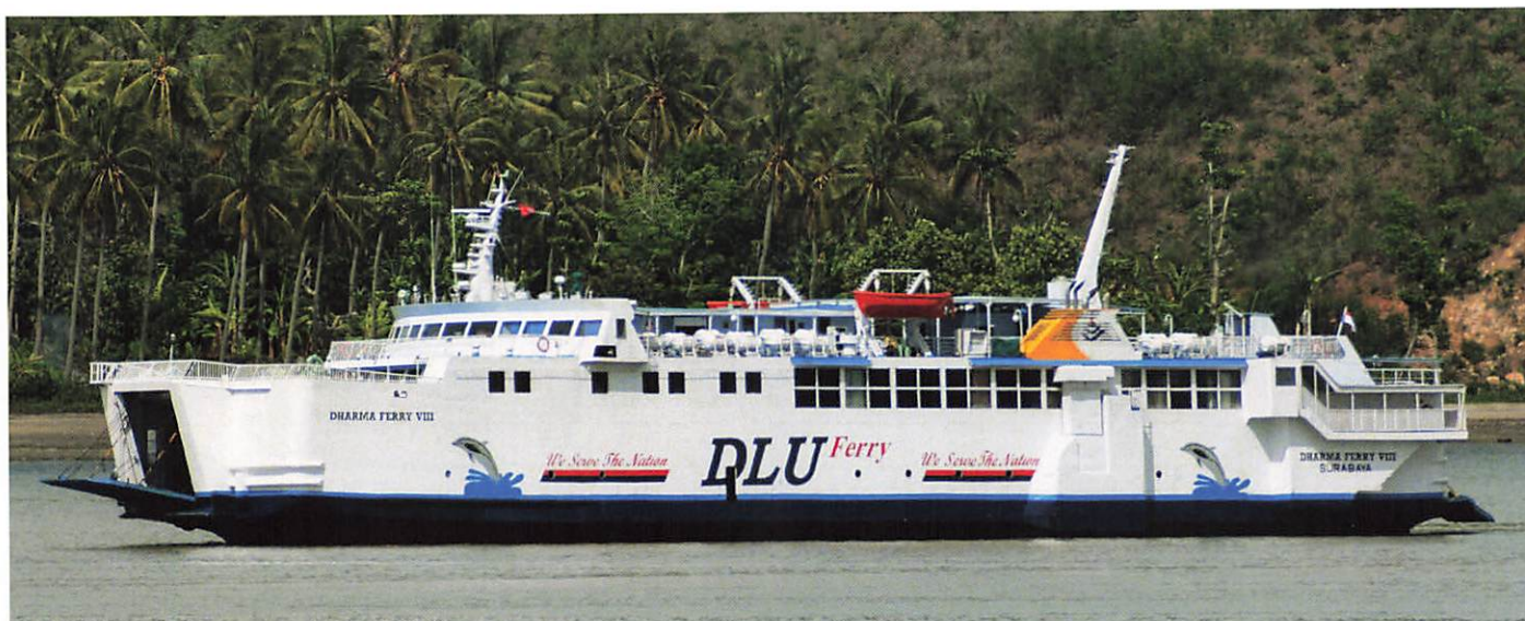
Foto oben: Die DHARMA FERRY VIII (2877 BRZ/Bj. 1991 als KOKUDO MARU) auf der Linie Lembar - Padangbai wurde nach dem Ankauf aus Japan im Jahr 2013 erheblich umgebaut. Neben dem angesetzten Bug fällt auch die außen angebaute und überdachte Gangway für Passagiere im Heckbereich auf. Foto: Gerolf Drebes
