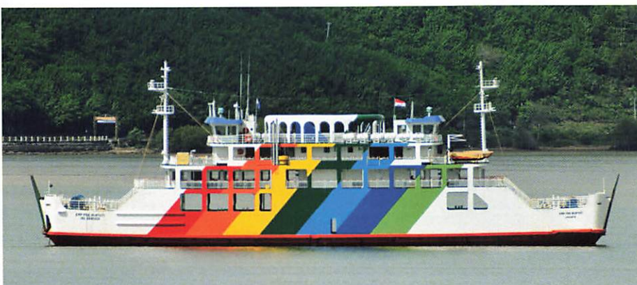
Foto links: Bunt geht es auch mit unserem Bilderbogen über die indonesische Fährwelt zuende, denn der zwischen Lembar und Padangbai eingesetzte Doppelender PBK MURYATI (850 BRZ/Bj. 1995 als OSHIMA NO. 12 ) zeigt sich besonders farbenfroh. Das Schiff ist 58,45 m lang, 14 m breit, bietet 350 Passagieren und gut 30 Autos Platz und ist hier ebenfalls auf der gut besuchten Reede vor Lembar zu sehen. Foto: Gerolf Drebes
