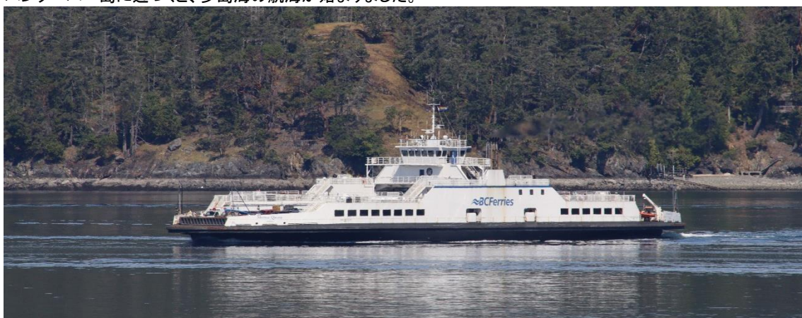
バンクーバー島周辺の離島を繋ぐ「スキーナ・クイーン」は両頭型の日本の離島航路でもよく見かけるタイプのフェリーです。1996 年建造、2653 総トン、旅客定員 441 名、乗用車換算で 92 台を積みます。
