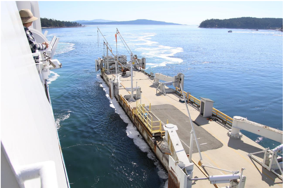
シュバルツ・ベイ港の栈橋には綱取りの人員はおらず、船上から綱がとれる簡易自動綱とり装置が設置されていました。
