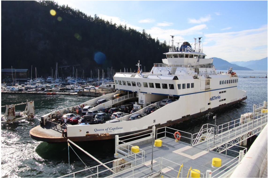
「クイーン・オブ・コーウィチヤン」の着岸を待って出港した「クイーン・オブ・カピラノ」Queen of Capilano。西バンクーバーのホースシュー・ベイと、近隣離島を結ぶ航路に就航しています。1991 年建造、2855 総トン。445 名の旅客と、87 台の車両が積載できます。
