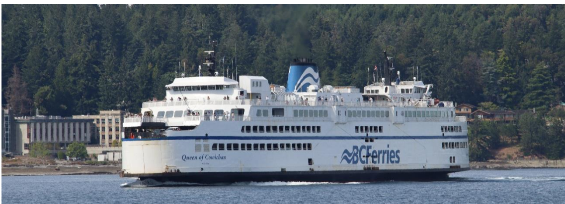
ナナイモのデパーチャー・ベイのフェリーターミナルから西バンクーバーのホースシュー・ベイまで乗船した「クイーン・オブ・コーウィチャン」Queen of Cowichan。1976 年建造で、船齢は 48 才ですが、内部は結構綺麗でした。6551 総トン、旅客定員 1460 名、乗用車換算で 312 台の車を積みます。
