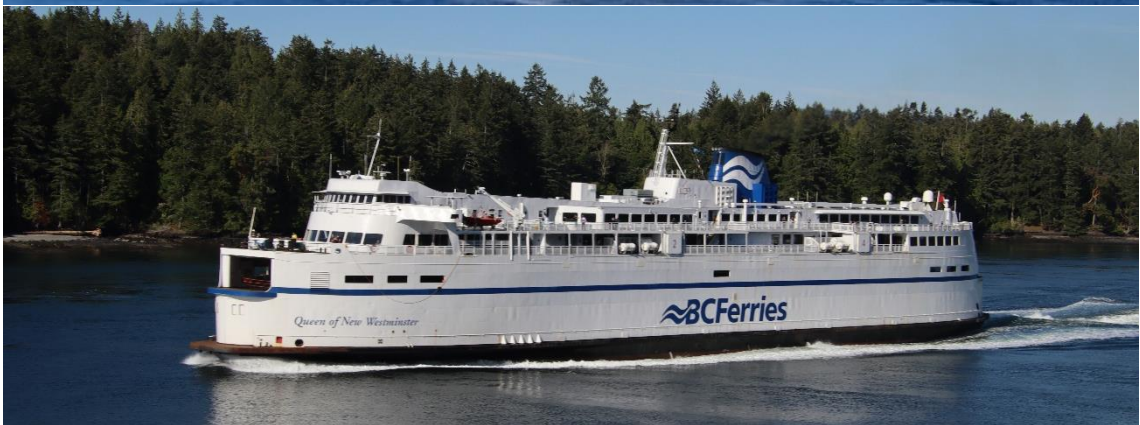
狭い水道で僚船「クイーン・オブ・ニュー・ウェストミンスター」と反航しました。1964 年建造で船齢はすでに 60 オ。8785 総トン、旅客定員 1303 名、乗用車換算で 254 台積みです。
