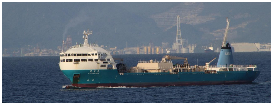
宇部港から出港してきたセメント船「清安丸」と交差しました。今回の旅行の 2 つ目の訪問先である「旭洋造船」の建造の船首球状ブリッジ構造のユニークに内航船です。
