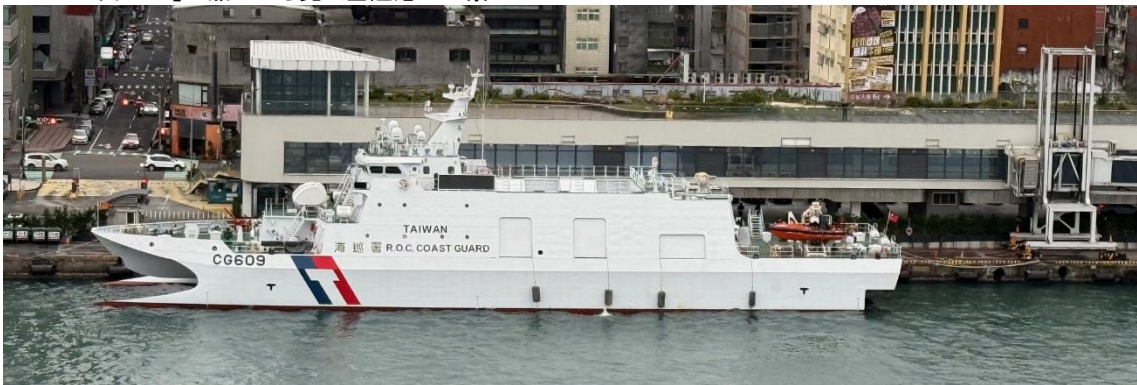
停泊する台湾の巡視船。ウェーブピアシング型の高速船。
