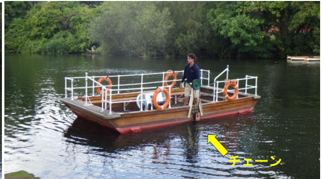
エイボン川の渡し船（チェーン・フェリー） 1回1£ 中央の人力の機械を回して両岸に渡されたチェーンを手繰る
