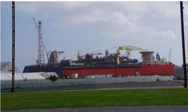
ハーランド・アンド・ウルフ造船所のドックで改装中の浮体式生産・貯蔵・積出船「Sea Rose FPSO」とドックのガントリー・クレーン 船は2004年韓国・サムスン重工建造 カナダのニューファンドランド沖の油田で稼働しているらしい
