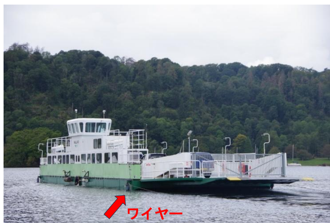
ウィンダミア湖の真ん中で稼働している両頭ワイヤー（チェーン）・フェリー「Mallaud」 両岸に渡したワイヤーを巻いて動いている
