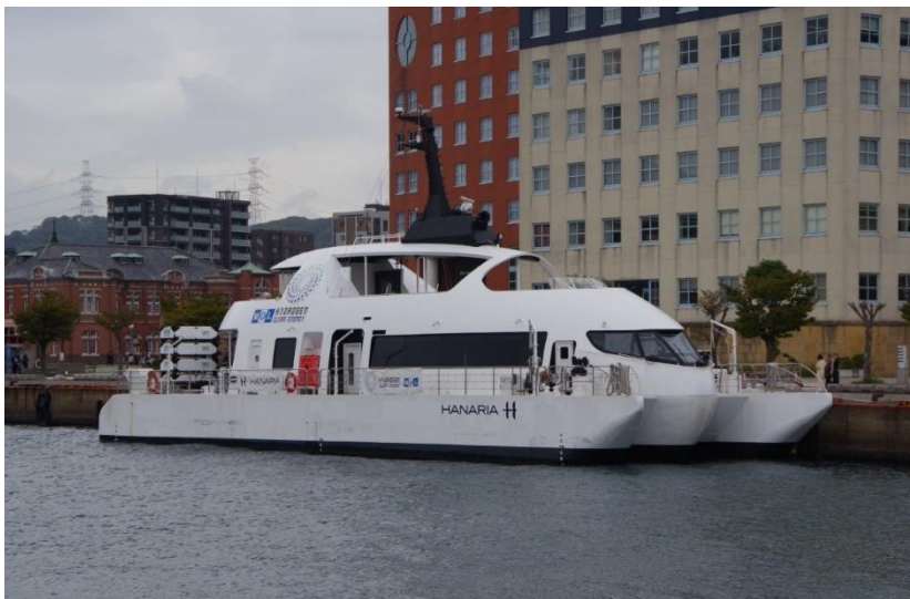
水素とバイオディーゼル燃料を活用したハイブリッド型電気推進船「ハナリア」とその船尾の水素タンク (右) 238GT 門司港にて 乗船してみたかったが、週末のみの運航のため今回は乗船できなかった
