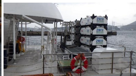
水素とバイオディーゼル燃料を活用したハイブリッド型電気推進船「ハナリア」とその船尾の水素タンク (右) 238GT 門司港にて 乗船してみたかったが、週末のみの運航のため今回は乗船できなかった
