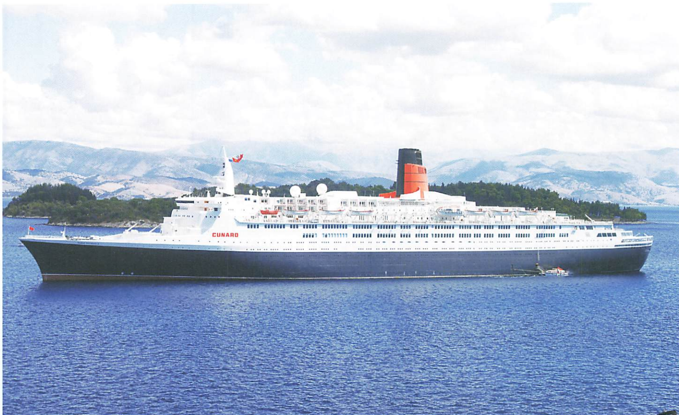
英名門キュナード・ラインの最後の定期客船として計画された「クイーン・エリザベス2」は、建造途中にクルーズ仕様に変更されてクルーズ客船として1969年に竣工した。65,863総トン、旅客定員2000人。2008年に引退し、ドバイでフローティングホテルとして開業した。
