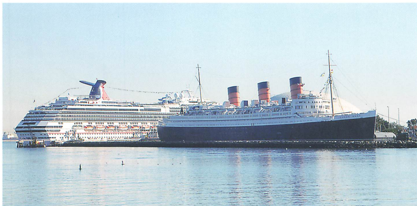
英キューナード社の「クイーン・メリー」は、1936年に完成して、英サウサンプトンと米ニューヨークの間の大西洋横断定期航路に就航した。総トン数80,774トン、最大速力32ノット、旅客定員2139名。現在、米ロングビーチでホテル兼博物館として使われている。後方に写るのはクルーズ客船「カーニバル・スプレnder」で112,562総トン。
