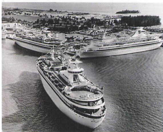
RCCLは「ソング・オブ・ノルウェー」、「ノルディック・プリンス」、「サン・バイキング」の3隻の1.8万総トン級の姉妹船を1970～1972年にフィンランドのバルチラ造船所で建造してカリブ海クルーズに投入した。煙突の中腹に展望ラウンジをもち、このユニークなラウンジは同社の全船にクラウンラウンジという名前で設けられている。
