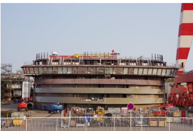
ドックの頭の先にある造船所展望園地から見た建造中の「MSC ワールド・アジア」とそのブリッジのブロック
