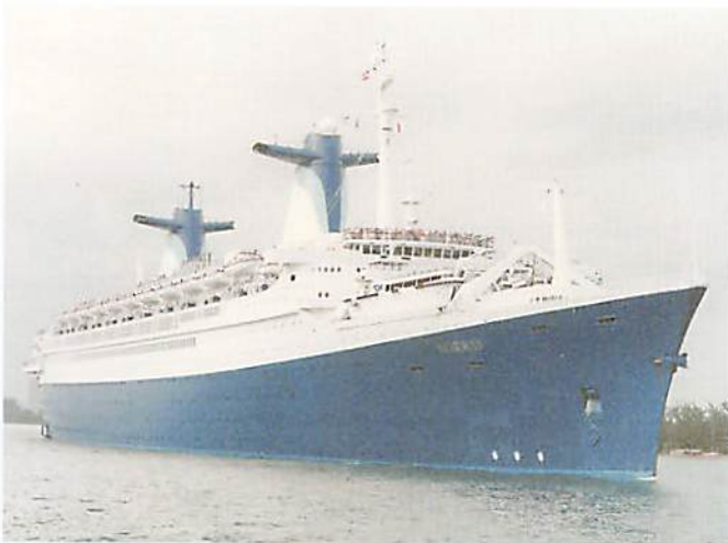
NCLの「ノルウェー」は、かつての大西洋横断定期船「フランス」を改造したクルーズ客船で、カリブ海クルーズにおけるクルーズ客船の巨大化の走りとなった。総トン数は7万総トン。カリブ海の島々では、喫水が深い船が着岸できる岸壁がないことも多いために、テンドーサービス用の巨大なボートを船首甲板に搭載していた。
