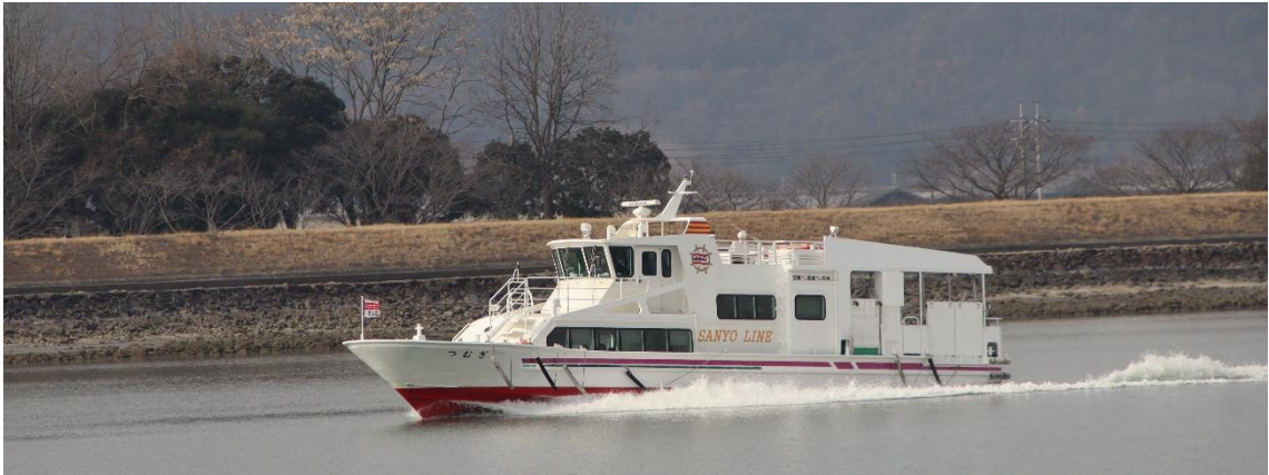
三洋汽船の「つむぎ」です。2022 年にツネイシクラフト&ファシリティーズで建造されています。19 総トン型アルミ船で、旅客 97 名、航海速力 23 ノットです。
