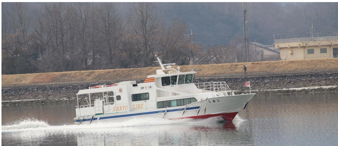
三洋汽船の高速旅客船「しおじ」です。2019年にツネインクラフト&ファシリティーズで建造されています。19総トン型アルミ船で、
