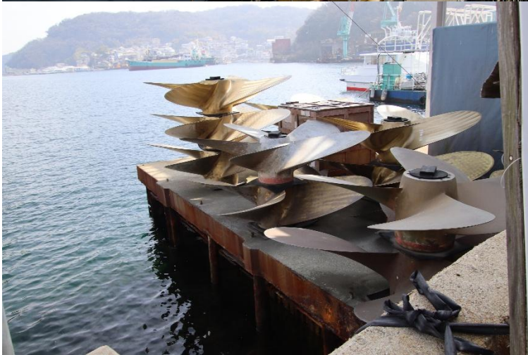
(上)家島の入り江の中にはたくさんの造船所がありました。(下)スクリュープロペラがたくさん台船の上にあります。家島の造船所では、小型内航船の修理がたくさん行われていることがわかります。
