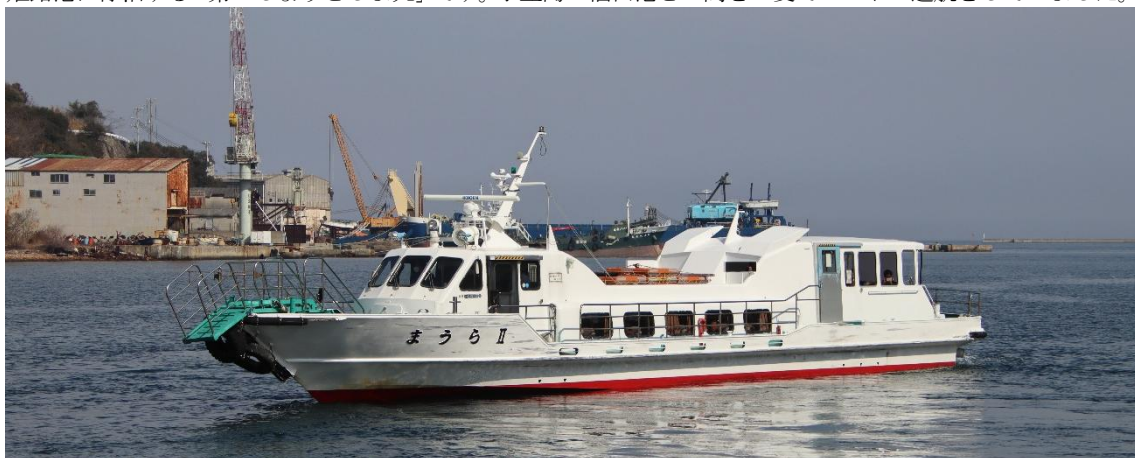
姫路港から家島の真浦港まで乗船した「まうらⅡ」です。典型的な 19 総トン型高速船で、最高速力は 31 ノット。2017 年の建造ですので、「日本の旅客船Ⅰ」にも掲載されています。船尾の暴露甲板にも座席があり窓がありますが、窓には文書が張られていたり、汚れていたりで写真の撮影は難しい状態でした。この座席の後ろには壁はなく、半透明のカーテンで仕切られていましたが、外に出たの撮影はできませんでした。
